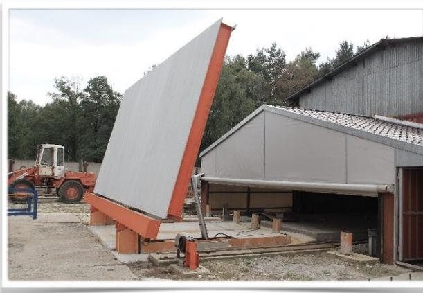
Système de mise en position verticale pour décoffrage
