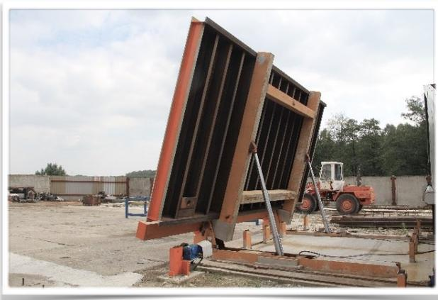
Vérins hydraulique pour mise en position verticale
